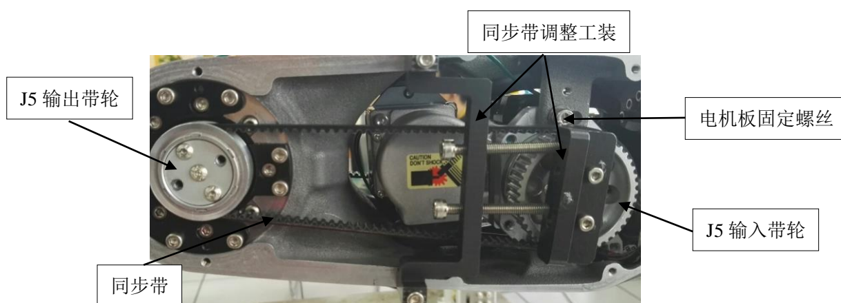
图 4.10 J5 关节同步带维护示意图
