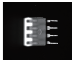
液态斜像远心镜头采用上述倾斜设置拍摄的后端脚图像
